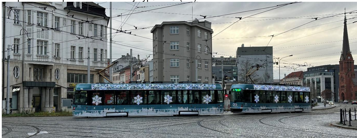
Souprava nízkopodlažních tramvají typu EVO (r o )
